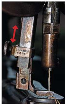
La longueur du point se définit elle même par la bague du pied qui doit être montée ou descendue.
