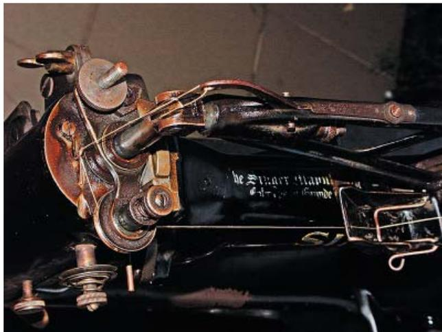
Autre possibilité, le circuit à tension variable, par le tenseur du haut. Il est possible de passer d'un tenseur à l'autre sans tout désenfiler!
