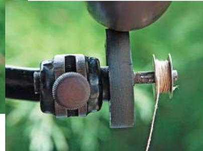
La canette s'enfile sur une tige légèrement conique, un excentrique et sa vis de réglage permettent sa prise sur le volant. On tourne le volant de haut en bas.
